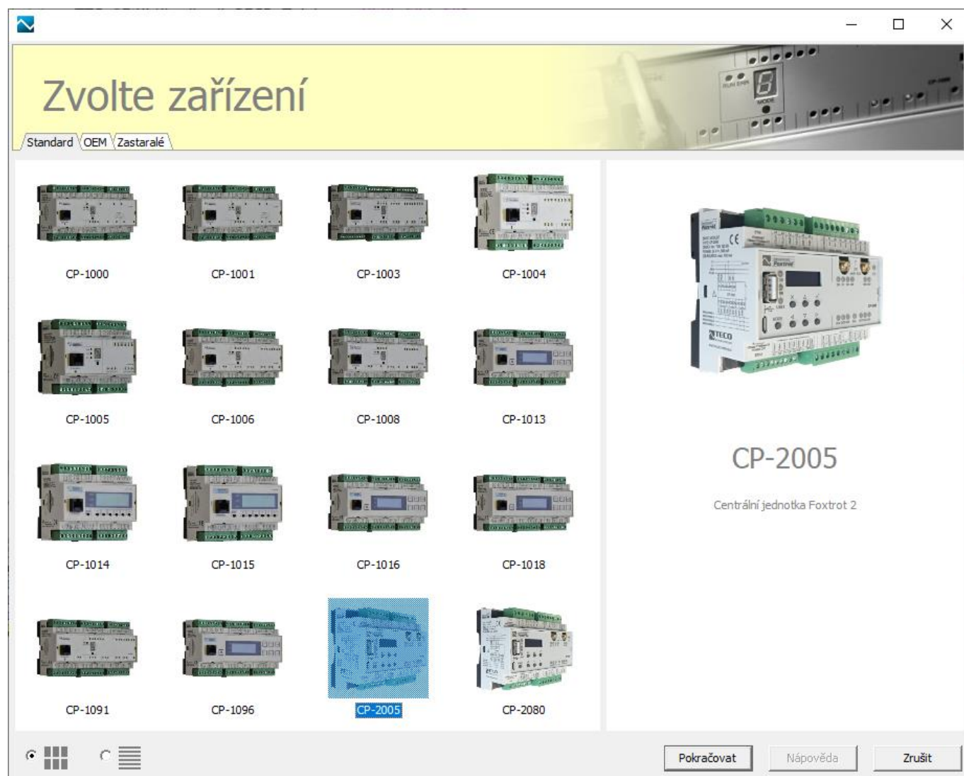
Obr.7.3 Výběr základních modulů PLC
