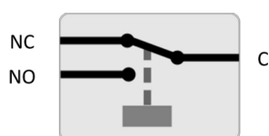
Konfigurace relé (bez napětí).
