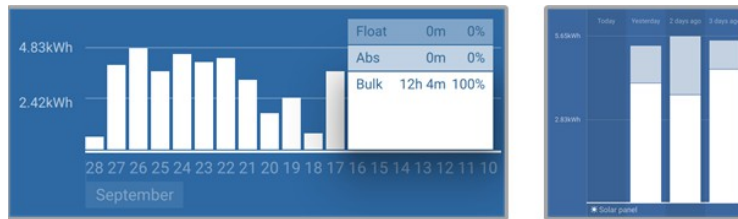
Vlevo: Příklad systému, který tráví veškerý čas v hromadné fázi. Vpravo: Rozdělení fází nabíjení - systém tráví čas v objemové fázi a ve fázi absorpce.
