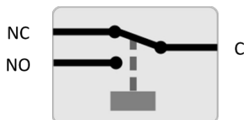
Vnitřní provoz programovatelného relé
