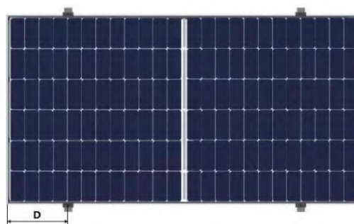
Instalace rámového modulu s úchytkami na dlouhých stranách Nosník kolmý na dlouhé strany (délka svorky \geq 40\text{ mm} )
