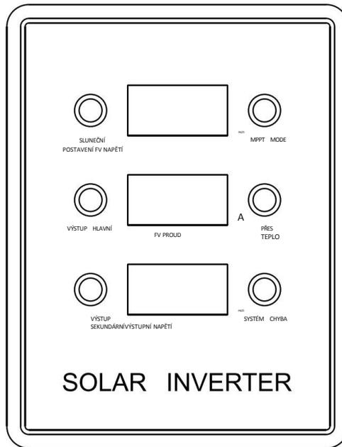
**SOLAR STATUS** - když je FV napětí větší než 80% jmenovitého napětí zařízení, indikátor se rozsvítí. Jinak bude blikat.
